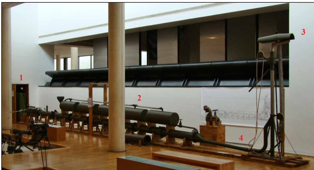
Een gereconstrueerde vlammenwerper van Livens in L'Historial de la Grande Guerre te Péronne. 1. Een gascilinder. 2. Brandstofvaten met olie. 3. De kop met brander. 4. De leiding waardoor de olie onder druk wordt geperst.
